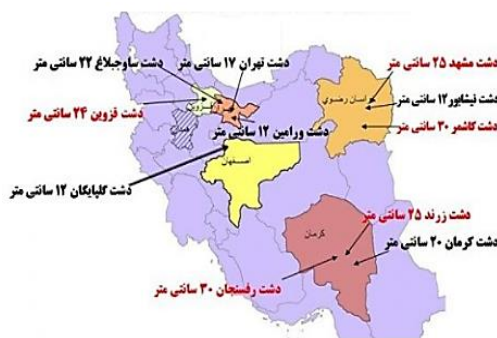
شکل ۴: فرونشست زمین در نتیجه تخریب سفره‌های آب زیرزمینی
